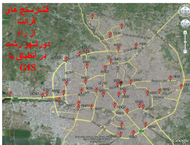
شکل (۱): کنترل فشار در مدل مدیریت هوشمند فشار شهر رشت
