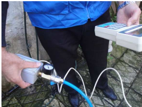
شکل (1): تست کنتورها در محدوده DMA
