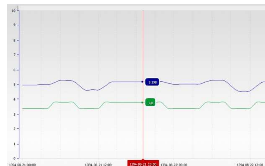
شکل (4): حداقل فشار خروجی فشار شکن در ساعات پیک مصرف
