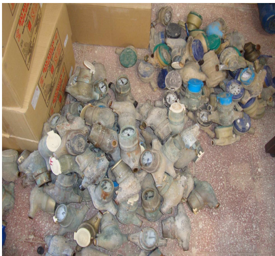
شکل (1): کتورهای فرسوده شهر همدان جهت بررسی تست عملکرد
