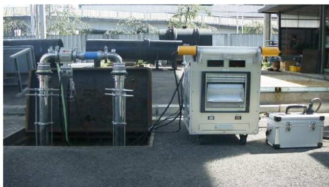
شکل (۱۰): فلومتر پرتابل (قابل حمل) و دستگاه ثبت دبی جهت محاسبه مینیمم مصرف شبانه
