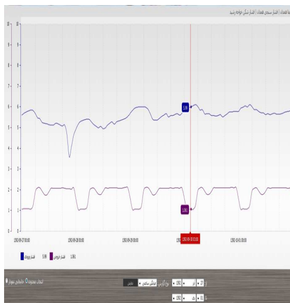
شکل (۴): خروجی فشار شکن بلوار خواجه رشید شهر همدان واقع در زون مخزن آزاد
